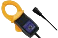
클램프 온 센서 9272-10 AC 20A/ 200A φ46mm 전원 : 9555-10
